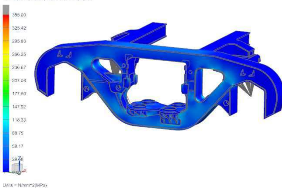
Obrázek 4.8 Redukované napětí na rámu pro případ 1
