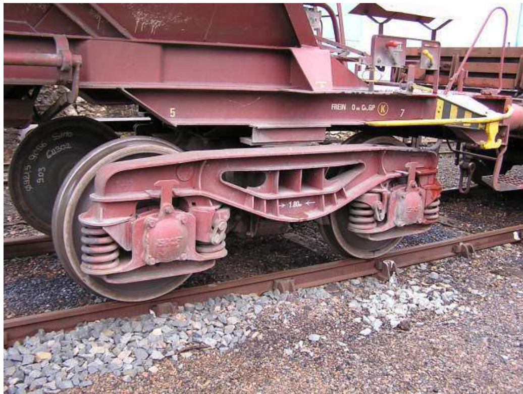
Obrázek 2.8 Podvozek Y27 se svařovaným rámem [11]
