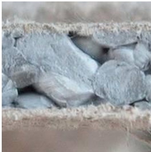
Obrázek 5 Ukázka vrstvení materiálu iboFoam
