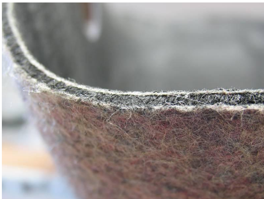
Obrázek 6 Ukázka vrstvení materiálu iboFelt
