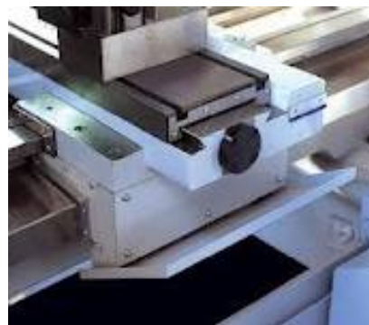
Obr. 7 Přímočaré vedení kluzné - rybinové
