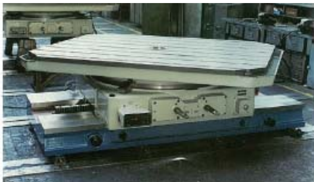
Obr. 8 Ukázka otočného (vlevo) a křížového stolu
