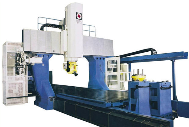
Obr. 5 Příklad uzavřeného rámu
