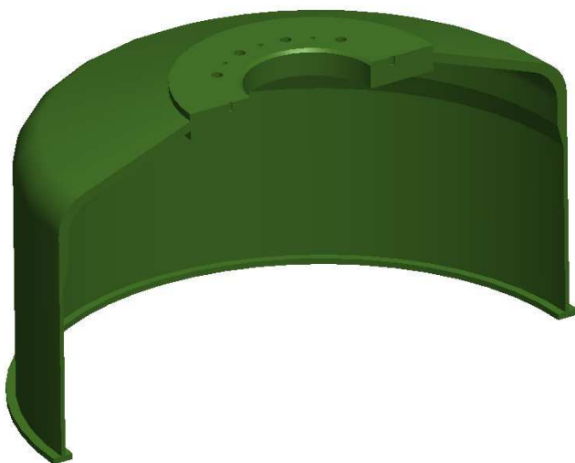
Obr. 4.1 - Původní komora s klenutým dnem
