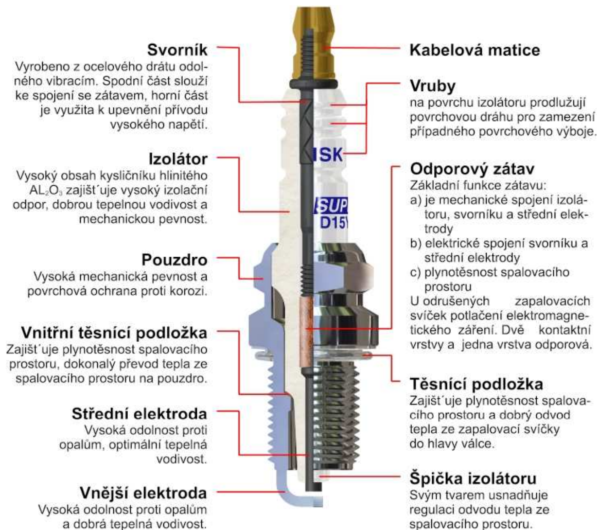
Obr. 3-8 Konstrukce zapalovací svíčky [29]
