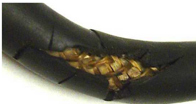
Obr. 5-4 Poškozená izolace zapalovacího kabelu [26]
