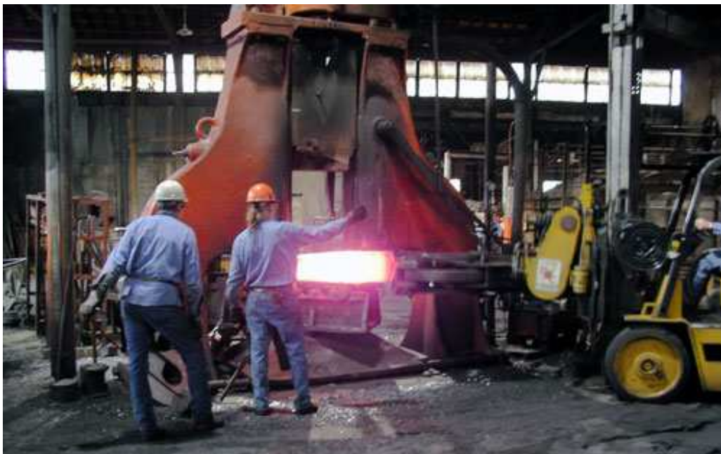
Obr. 1.1: Buchar chambersburg firmy Ajax-Ceco při kování háku, [4]
