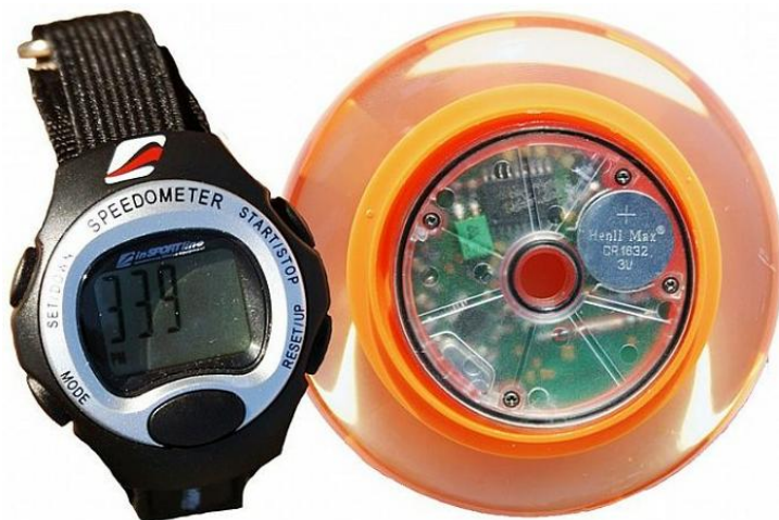
Obr. 5 Speciální kolečko měřící rychlost in-line brusle se zobrazením na hodinkách [5]
