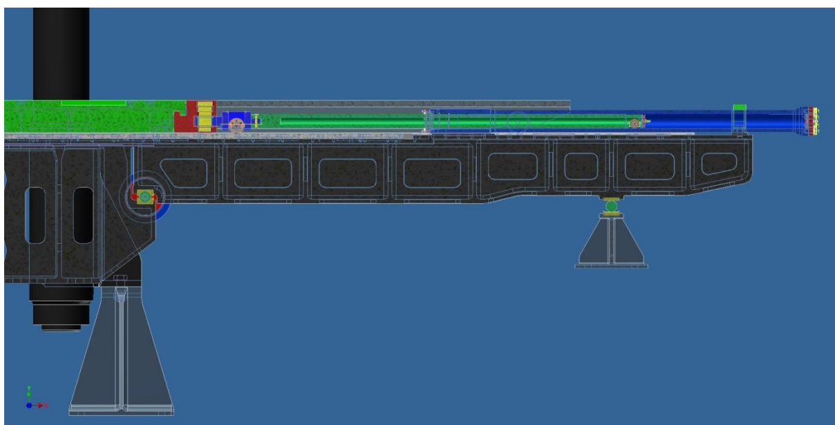
Obr. 4.1.4. Pravá strana sestavy posuvu stolu v řezu
