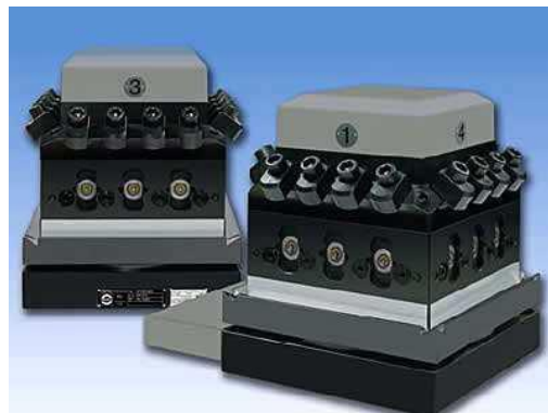
obr. 10 Revolverová hlava pro 16 nástrojů (zdroj: skripta ZSVS/KOS3)
