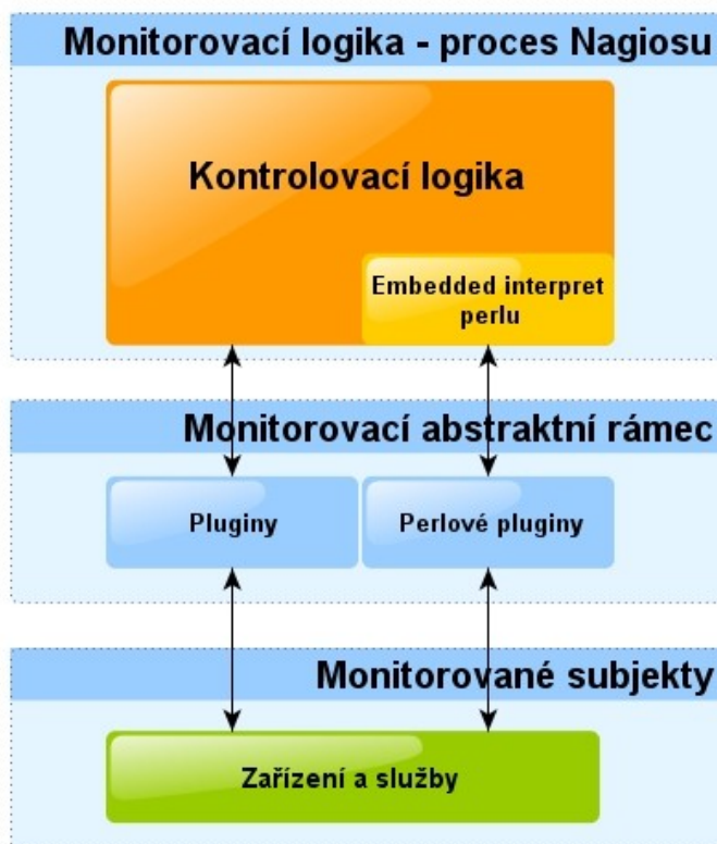
Obrázek 3.1: Vrstvy aktivní monitorovací logiky softwaru Nagios
