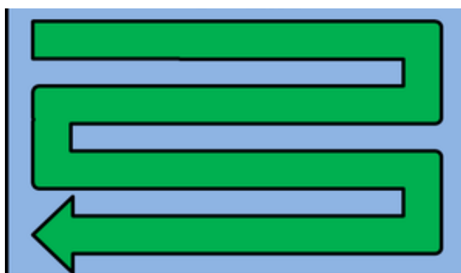
Obrázek 1.4-3: Prostorové rozložení pracovišť do tvaru S.[36]
