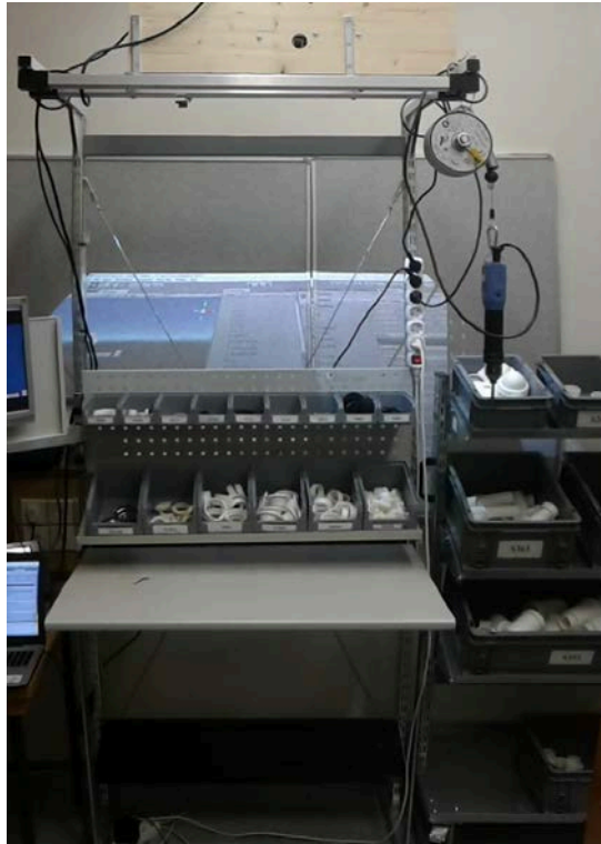
Obrázek 4.23: Montážní pracoviště reálného modelu sifonu [vlastní tvorba]
