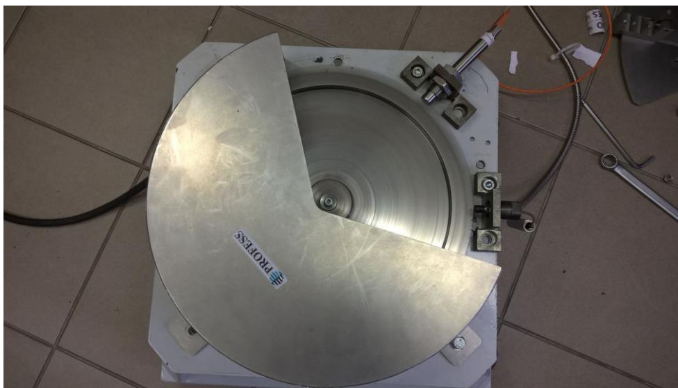
Obrázek 13: Simulátor otáček s osazenými snímači
