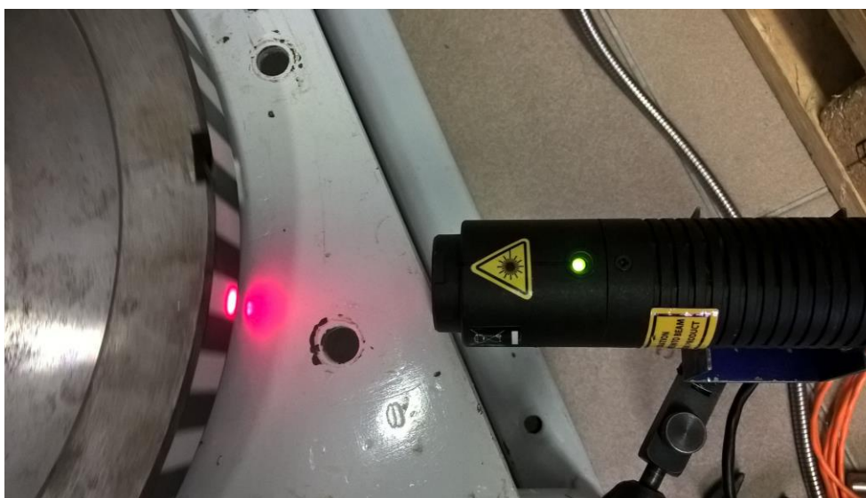
Obrázek 16: Optický senzor otáček
