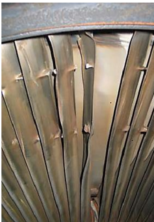
Obrázek 7: Lopatky zdeformované působením torzních kmitů hřídele [3]
