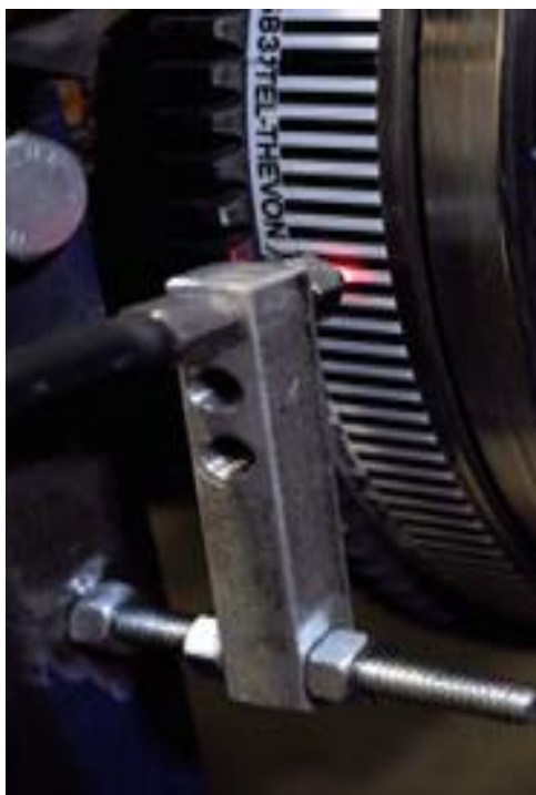
Obrázek 10: Ukázka měřicího místa snímání torzních kmitů pomocí optického snímače [11]
