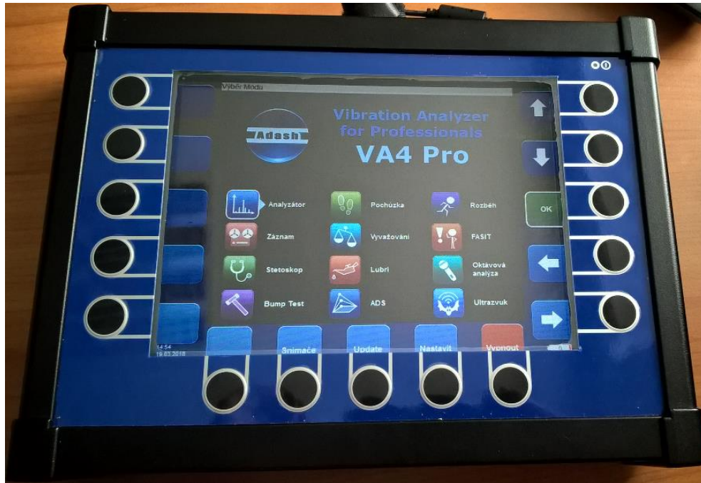
Obrázek 17: Hlavní obrazovka přenosného analyzátoru VA4 Pro
