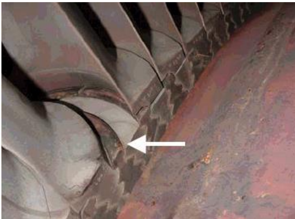
Obrázek 8: Únavová prasklina u kořene lopatek nízkotlakého dílu turbíny[8]
