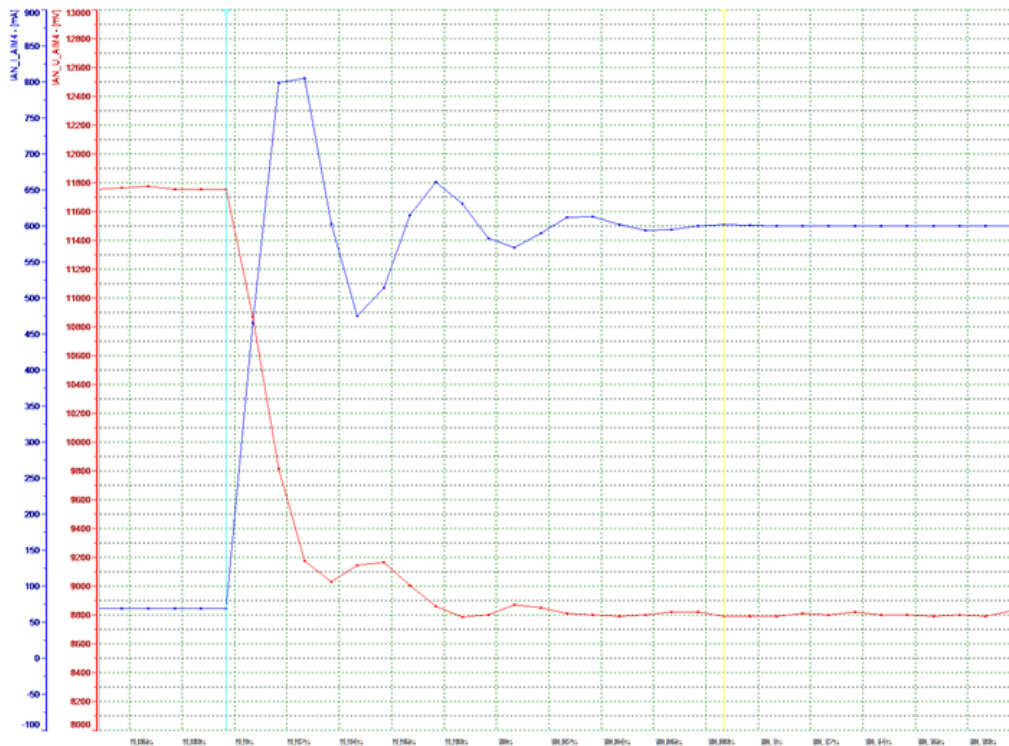
Obrázek 36: Náběh proudu, změna 33 - 600mA, výstup z programu Canape, vlastní model
