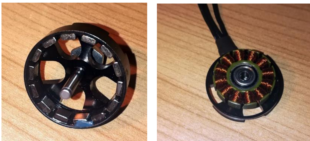
Obr. 6: Rotor a stator BLDC motoru pro malý, nebo závodní dron (nízká výška a 2300KV)
