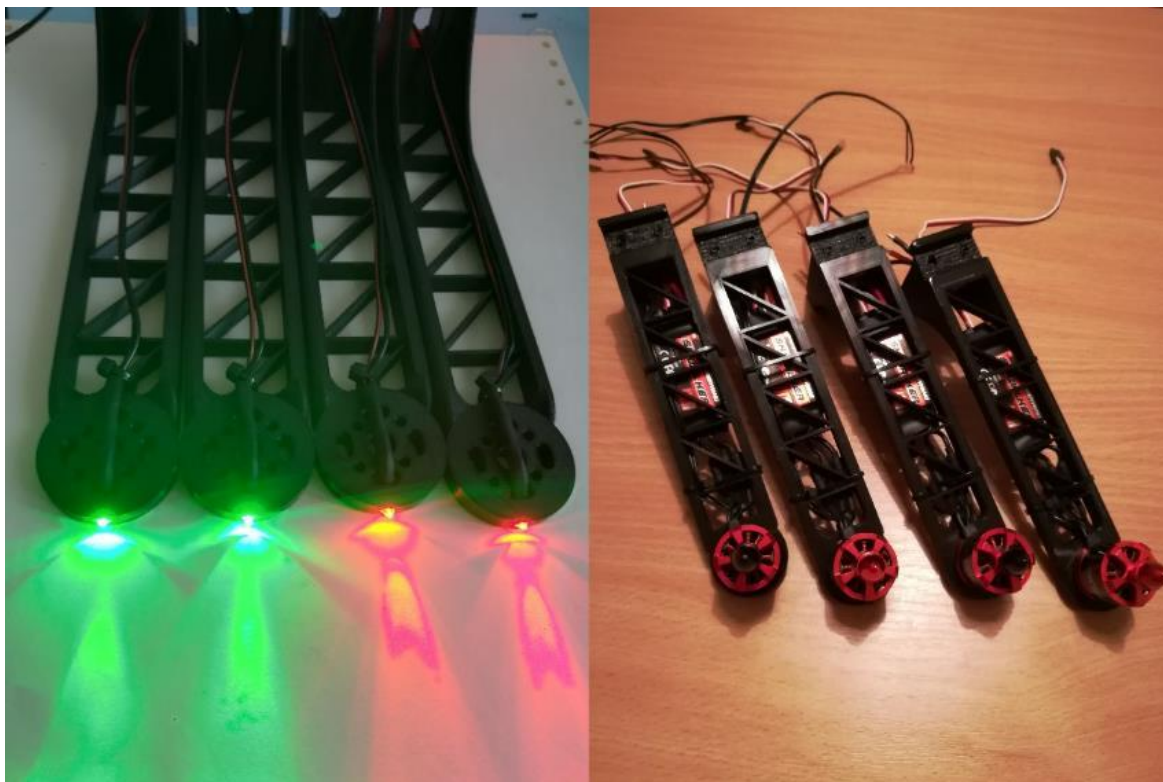
Obr. 22: Poziční LED diody a konečné sestavení ramen, včetně všech komponent.
