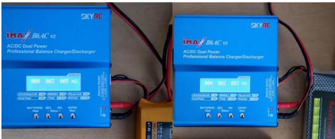
Obr. 15: Hodnoty vnitřního odporu R_i jednotlivých článků u dvou různých značek akumulátorů s kapacitou 5200 mAh 35C.
