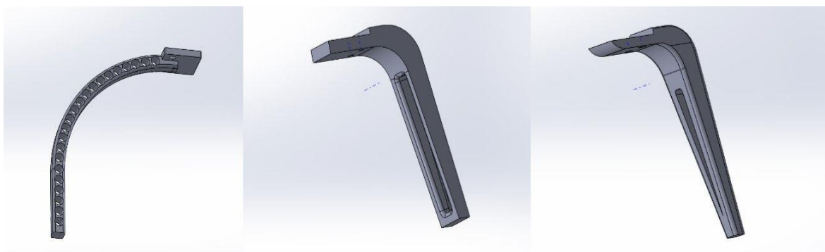
Obr. 17: Návrhy provedení konstrukce podvozkových nohou.
