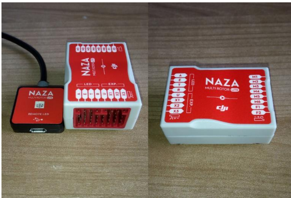
Obr. 9: Řídicí jednotka od firmy DJI verze NAZA Lite, včetně signalizační diody a USB konektoru.
