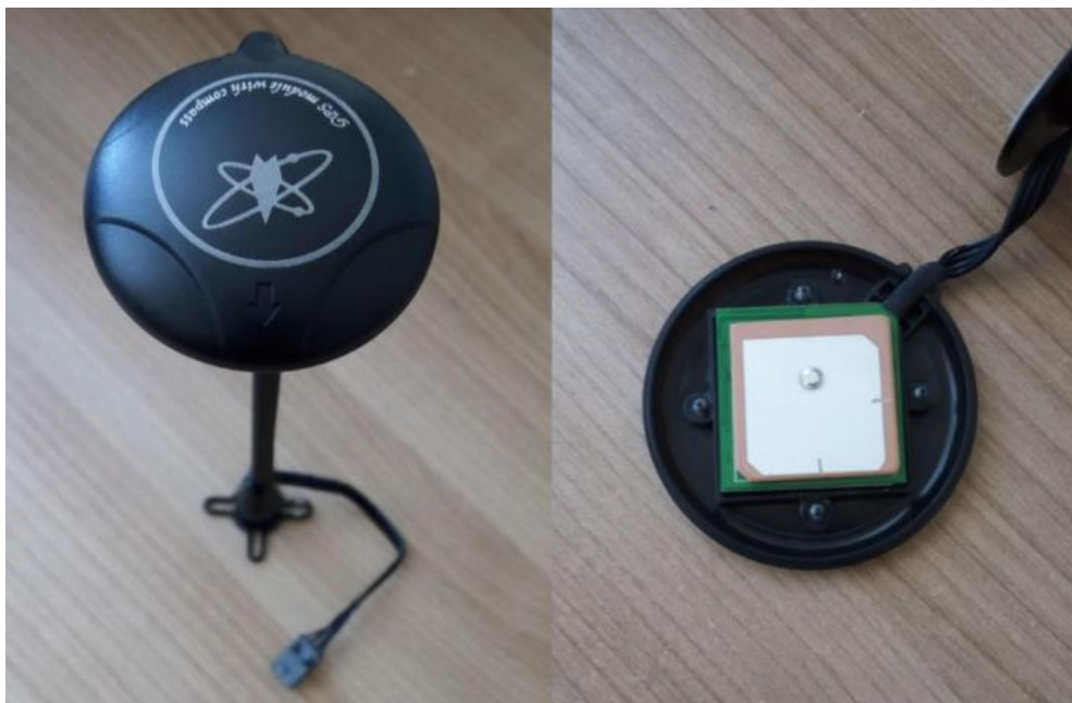
Obr. 10: Snímač GPS signálu umístěný na dlouhém držáku a s odhalenou keramickou anténou.
