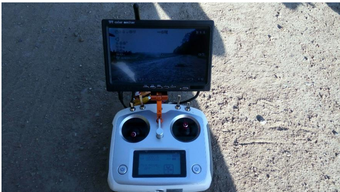
Obr. 25: RC ovladač včetně monitoru s obrazem z čelní kamery a telemetrickými daty.
