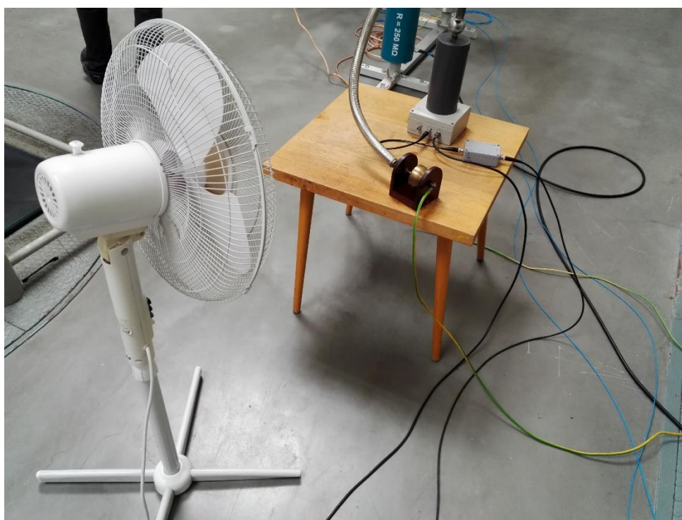
Obr. 4.20 Experimentální měření s použitím vnějšího ofukování kalibračního jiskřiště pro napěťovou hladinu 13,9 kV DC pozitivních výbojů – Zdroj: Modulární systém GBS 13/270
