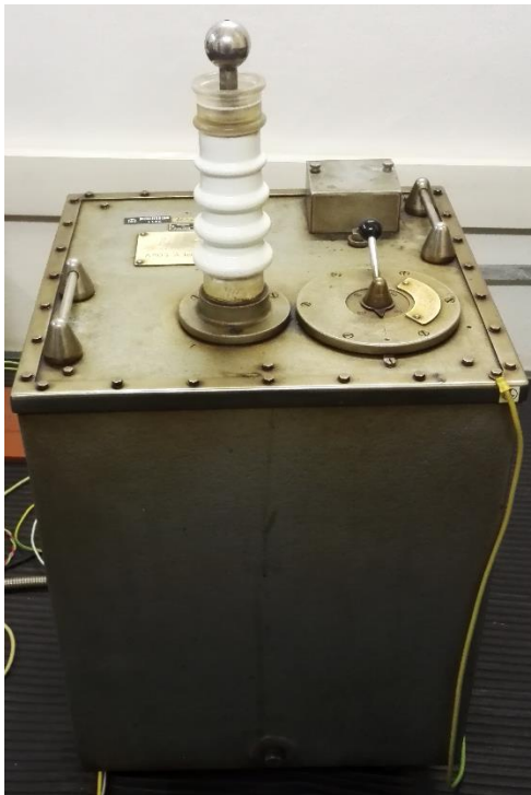
Obr. P. 1.4 Vlastní zdroj vysokého napětí Tesla BS 222a
