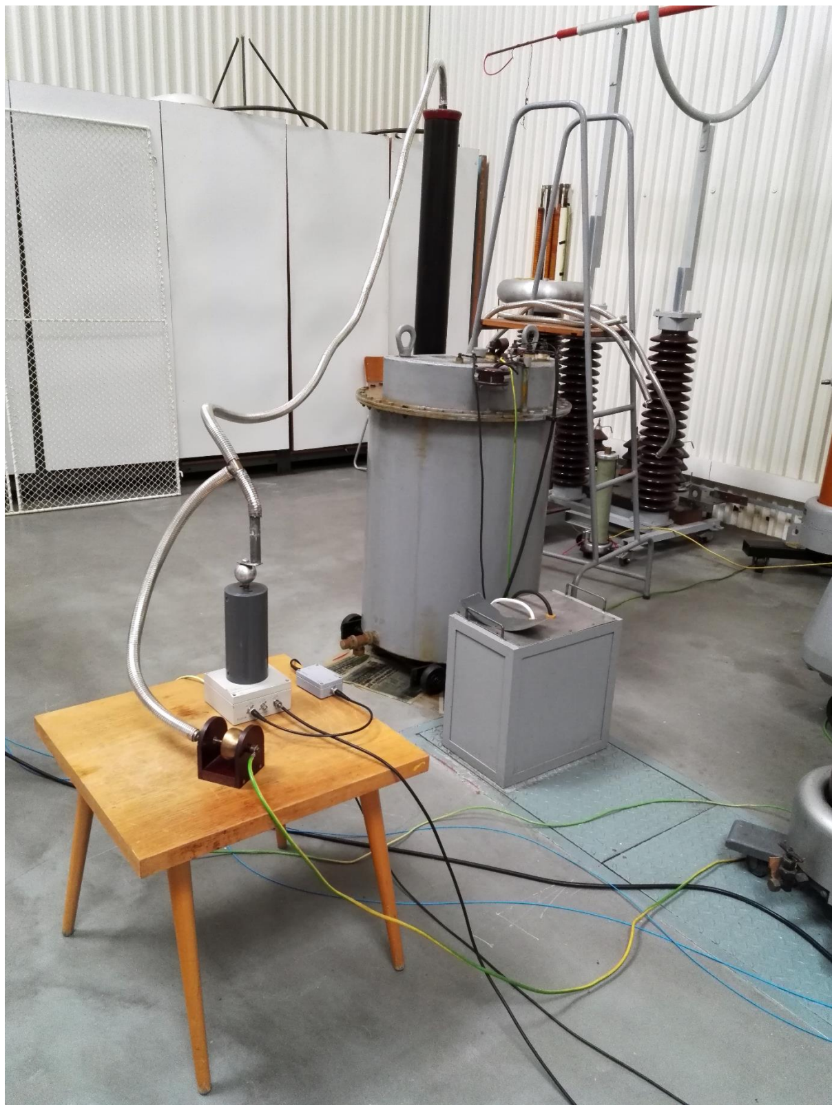
Obr. P. 1.6 Fotografie zapojení pro měření částečných výbojů na AC napětí, zdroj: Transformátor ČKD
