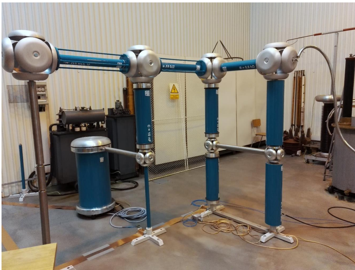
Obr. 3.12 Modulární systém GBS 13/270 – zapojený pro měření na negativním DC napětí
