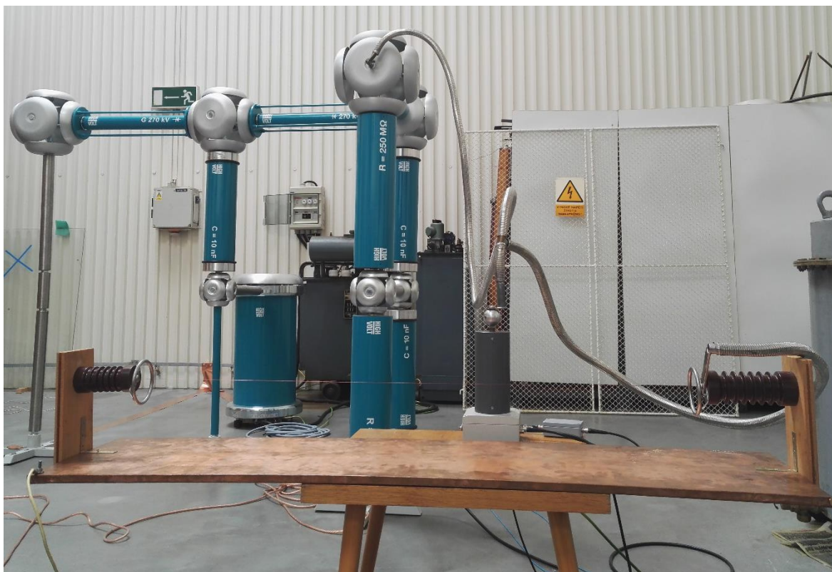
Obr. 3.11 Model VN vedení – fotografie z měření částečných výbojů na negativním DC napětí
