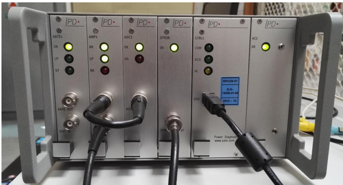
Obr. 3.1 Měřicí přístroj ICMsystem používaný v prostoru vysokonapěťové laboratoře KEE
