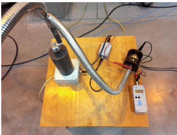
Obr. 3.13 Připojený kalibrátor na kalibračním jiskřišti [4]
