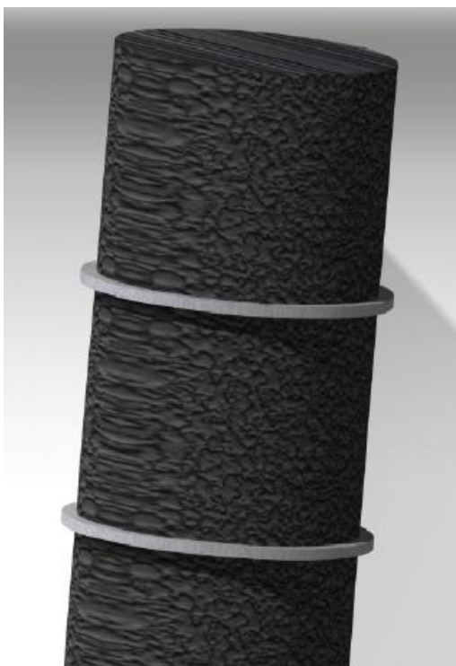
Obr. 6: Vizualizace návrhu paliva s vrstvami Th mezi palivovými peletkami [32]
