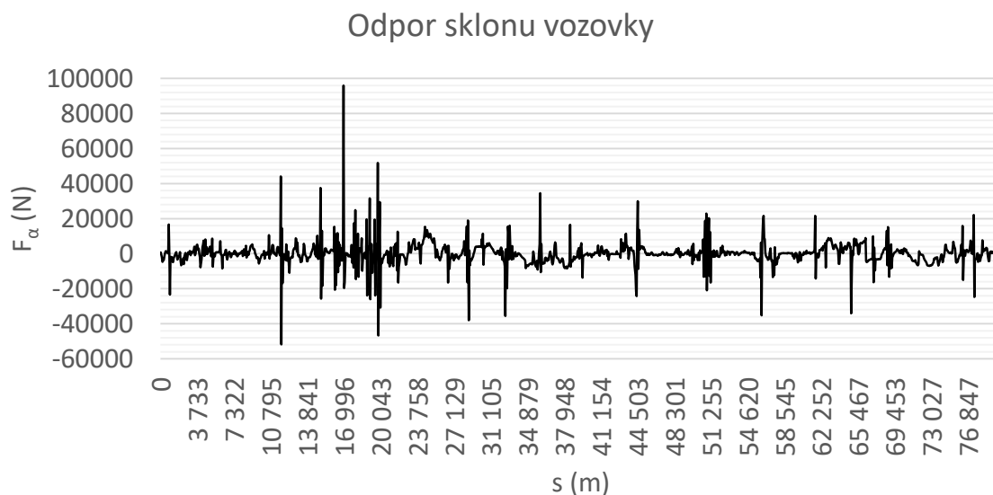
Obr. 4.19: Působení odporu sklonu vozovky na vozidlo
