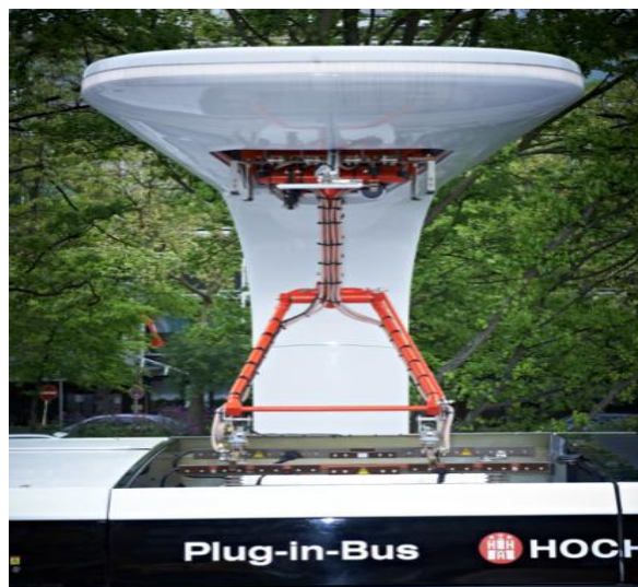
Obr. 3.1: Pantograf dobíjecí stanice dosedající na kontakty, které jsou součástí elektrobusu (převzato z [34])
