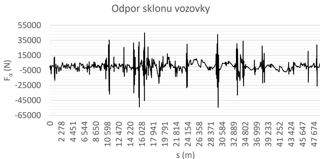
Obr. 4.7: Působení odporu sklonu vozovky na vozidlo
