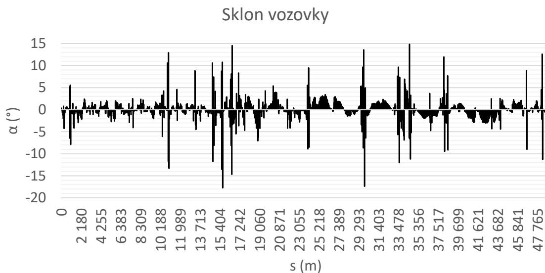
Obr. 4.3: Znázornění sklonu vozovky na trase vozidla
