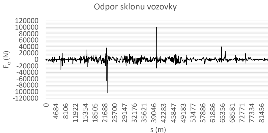
Obr. 4.31: Působení odporu sklonu vozovky na vozidlo
