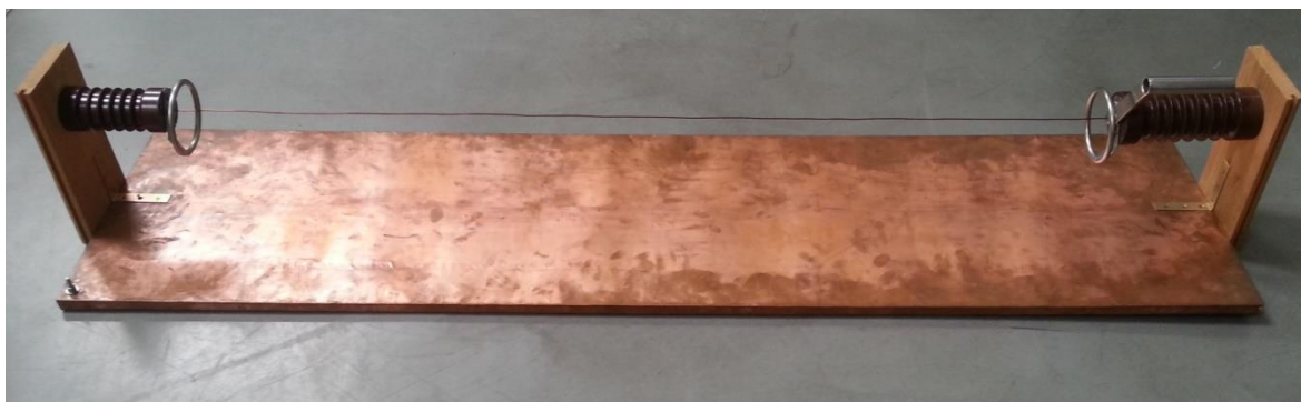
Obr. 7_Celkový pohled na model jednoduchého vodiče 1,6 mm
