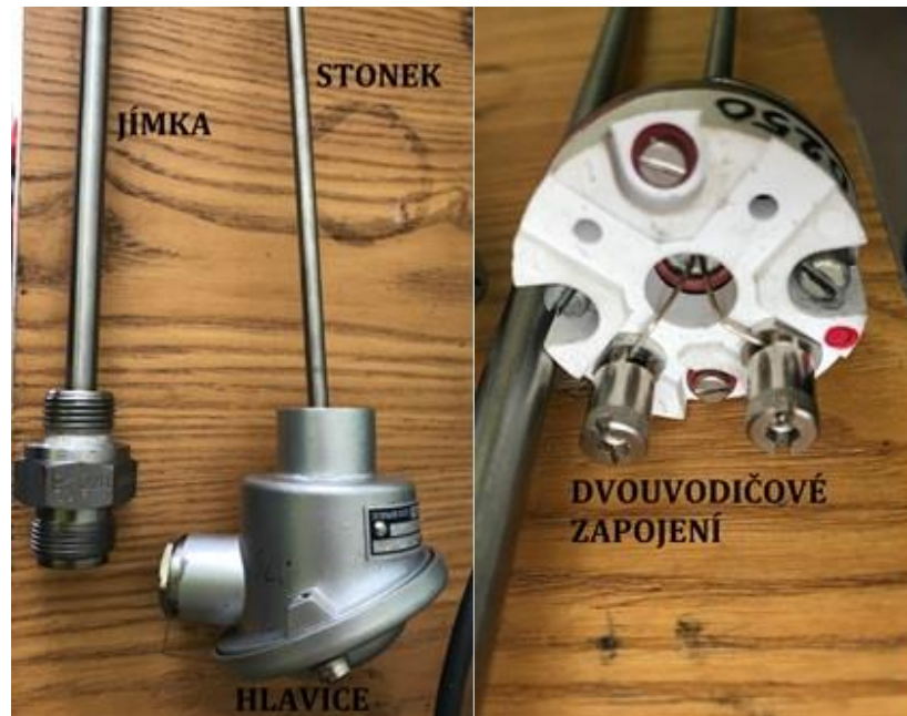
Obrázek 2.2: Ukázka složení a zapojení odporového snímače teploty. Zdroj vlastní
