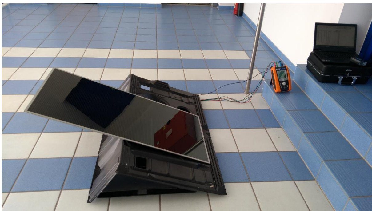
Obr. 2.3: Měření chlazení fotovoltaického panelu uvnitř budovy
