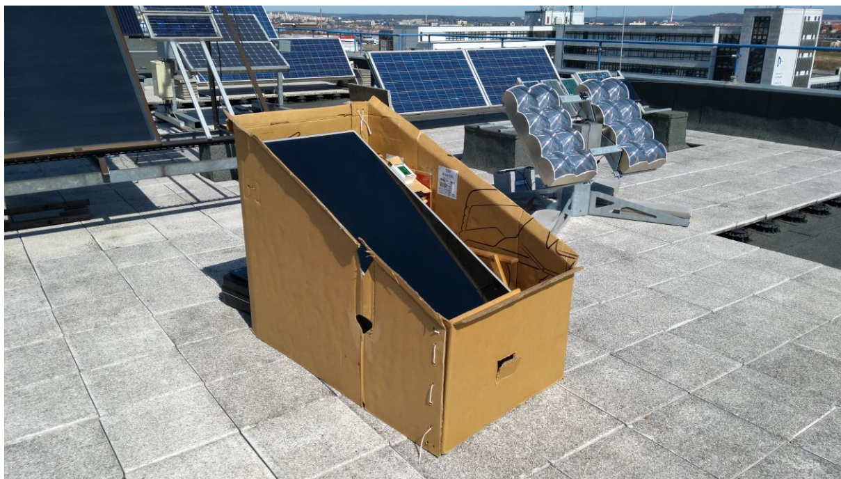
Obr. 2.1: Měřicí konstrukce pro měření fotovoltaického panelu
