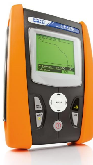
Obr. 2.5: Přístroj pro měření voltampérových charakteristik analyzátor HT I-V400 [15]
