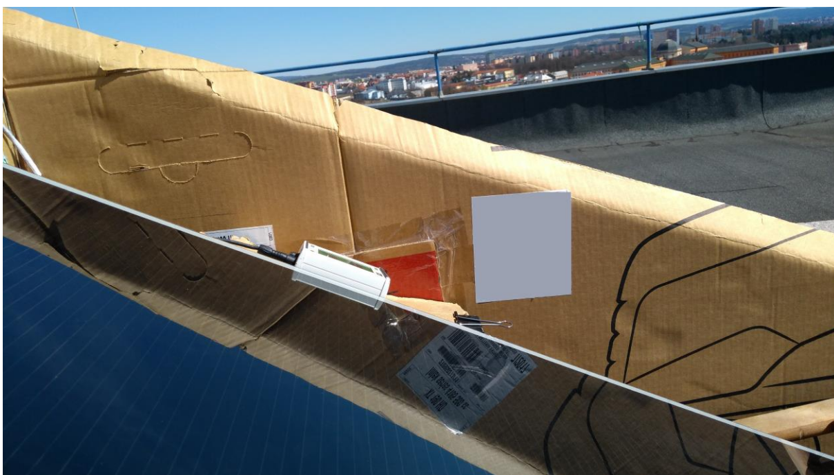
Obr. 2.6: Detail na správně umístěný snímač dopadající intenzity slunečního záření
