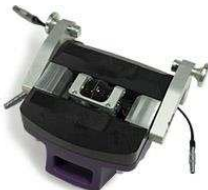
Obrázek 12 - SCORPION2 firmy Silverwing (ultrazvuková sonda) [18]
