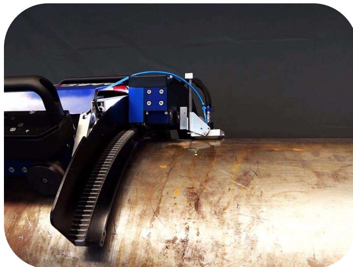
Obrázek 10 - FAST UT s tvarovým držákem sondy firmy GE Robotics Inspection [14]
