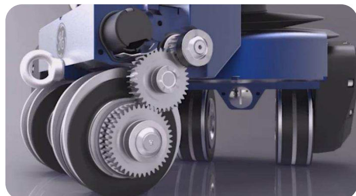
Obrázek 6 - BIKE PLATFORM firmy GE Robotics Inspection (převodový mechanismus pohonu) [12]
