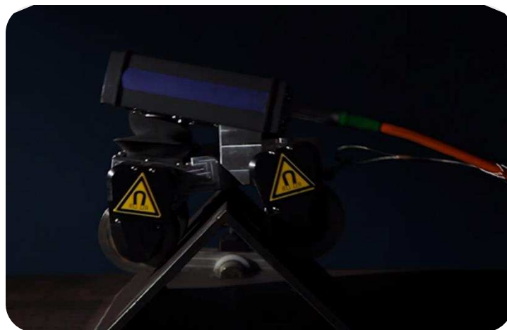
Obrázek 4 - BIKE PLATFORM firmy GE Robotics Inspection (překonávání překážek) [12]
