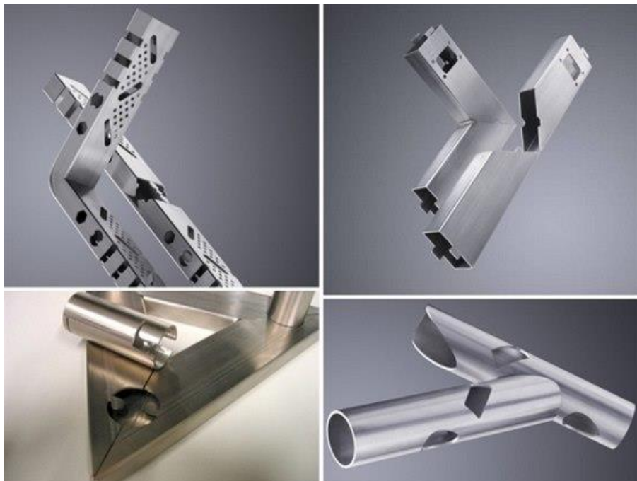
Obrázek 36 Ukázka laserově řezaných dílů [4]
