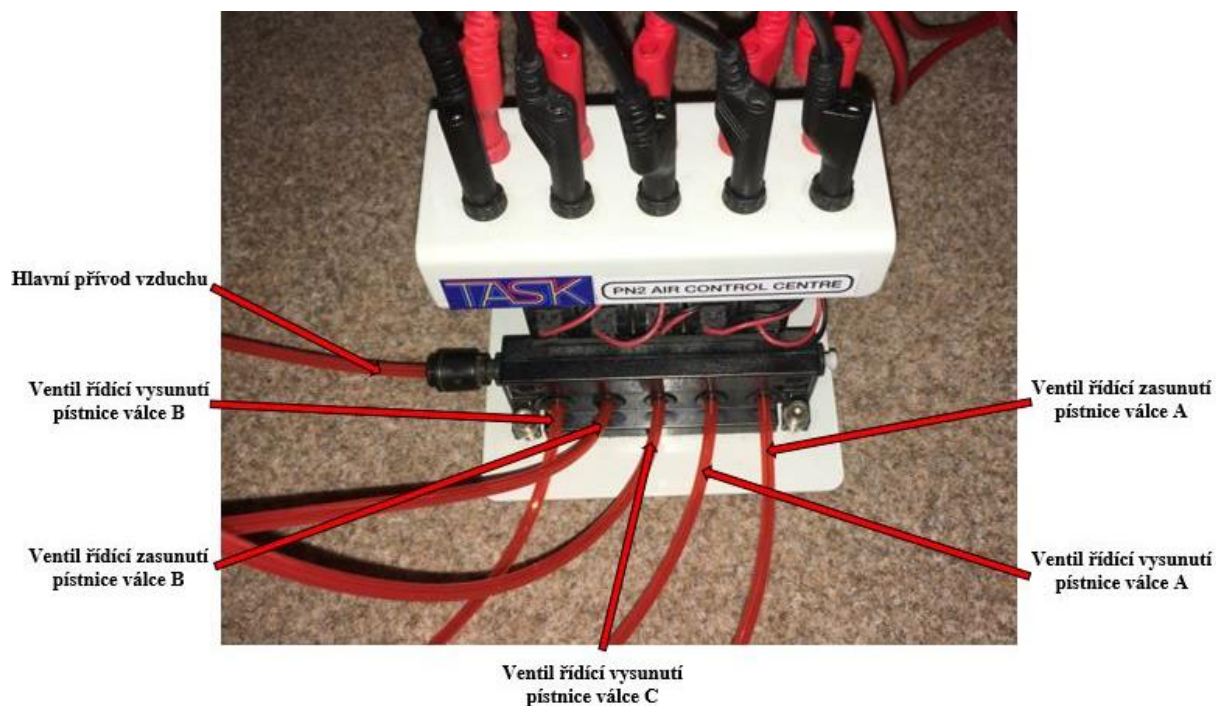
Obr. 31 Schéma připojení vzduchu k elektromagneticky ovládaným ventilům
