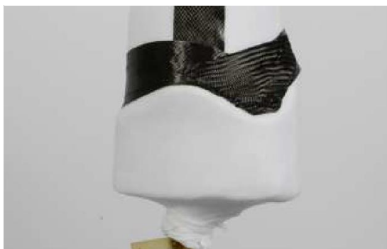
Obrázek 69 Polohování karbonové tkaniny v oblasti hrbolu kosti sedací
