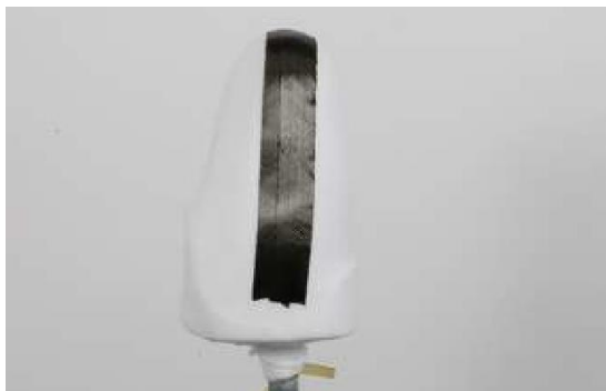
Obrázek 66 Karbonový pás na laterální straně
