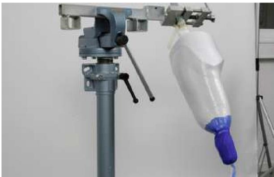
Obrázek 70 Poloha modelu při laminování
