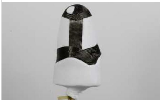
Obrázek 68 Polohování karbonové tkaniny na distálním konci pahýlu
