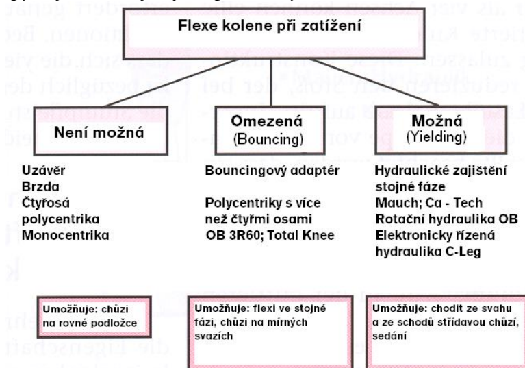
Obrázek 17 Principy zajištění stejné fáze protézových kolenních kloubů.
