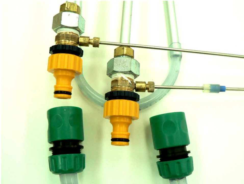
2 Ukázka napojení potrubí na hadice s adaptéry pro ukotvení termočlánků
