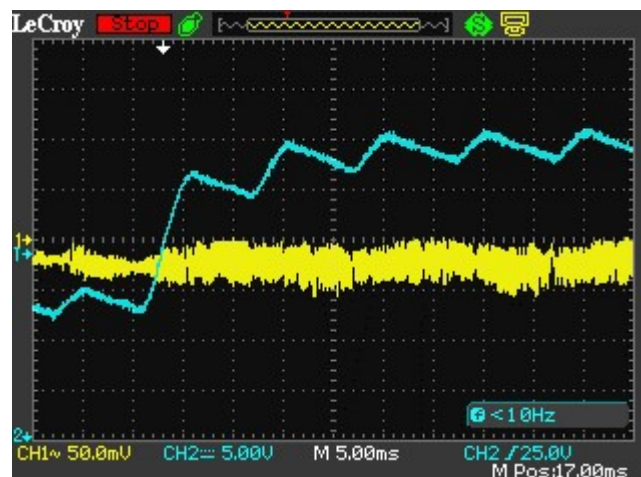
Obr. 11.4 Zvlnění signálu při přepojení odbočky transformátoru
