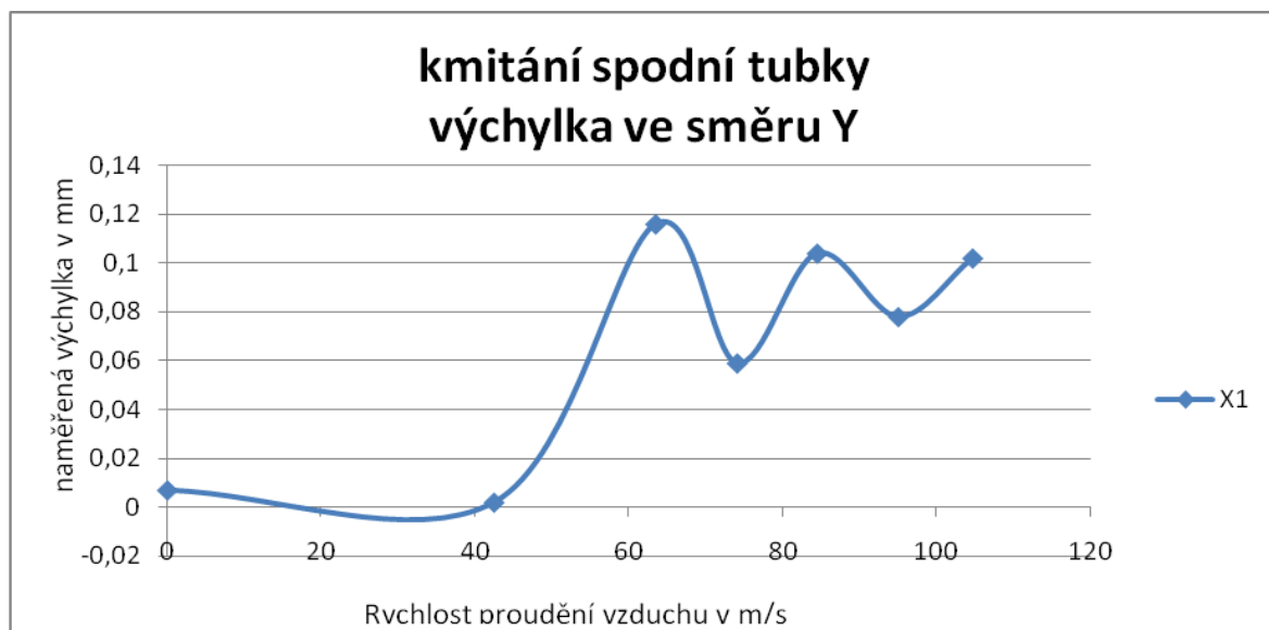
Obr. 2.8. Závislost výchylky ve směru Y na rychlosti proudění vzduchu při kmitání spodní trubky
