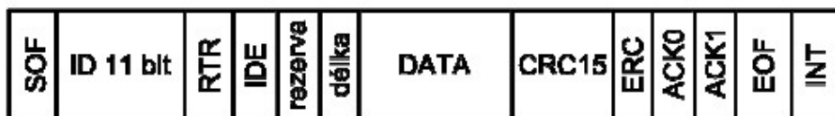
Obr. 2.4 Struktura datové zprávy [15]
