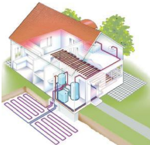
Obr. 1.5 Tepelné čerpadlo země-voda s půdním kolektorem [6]
