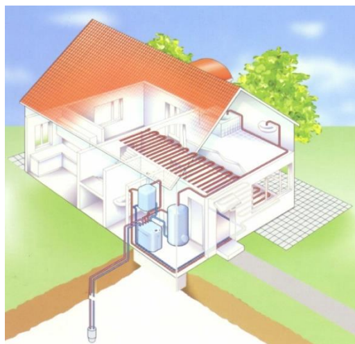
Obr. 1.4 Tepelné čerpadlo země-voda se zemním vrtem [6]
