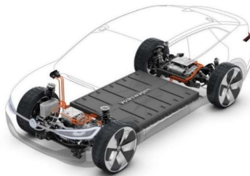
Obr. 7 Uložení akumulátorů na podvozku elektromobilu [35]
