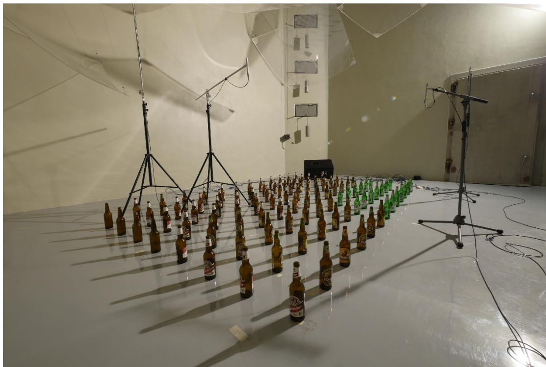
Obr. 5.5 Fotografie rozmístění lahví v dozvukové místnosti
