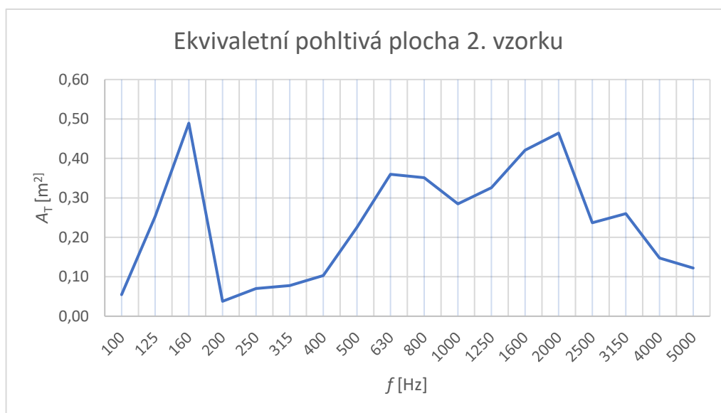
Obr. 5.8 Ekvivalentní pohltivá plocha 2. vzorku závislá na frekvenci
