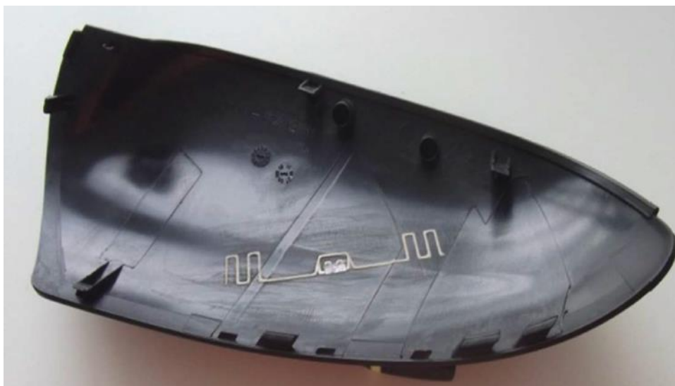
Obr. 20: Ukázka natištěné antény s RFID čipem uvnitř plastového zrcátka auta (převzato z [4])
