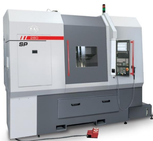
Obrázek 5.1.5-1: Číslíkově řízený soustruh SP 280 SY [6]
