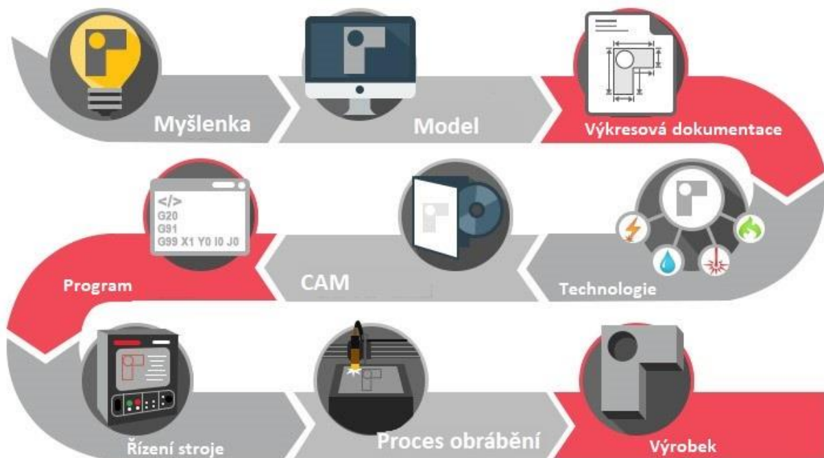
Obrázek 2-Schéma procesu výroby za použití CAD/CAM systémů [11]
