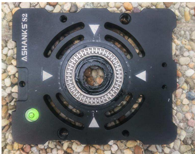
Obr. 18 – Půdorys vozíku s odejmutou horní miskou ložiska.
