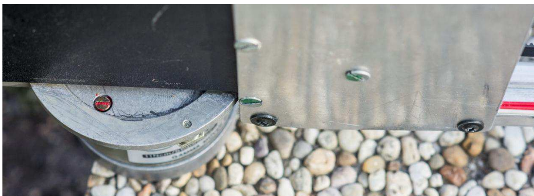
Obr. 5 - Přesah motoru pod úroveň konstrukce, nutno použít podpěrné nožičky.
