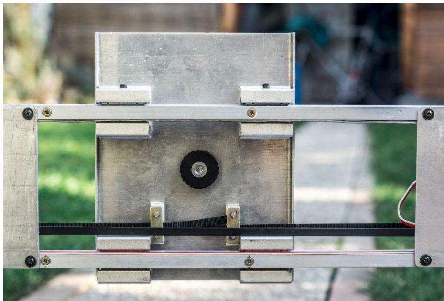
Obr. 6 - Spodní strana vozíku, řemenové svěrky, stativový šroub.
