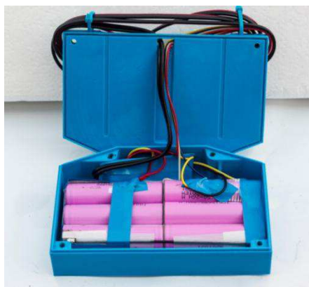
Obr. 41 – Odkrytí pouzdra baterie, LiIon články 18650 s ochranou elektronikou.
