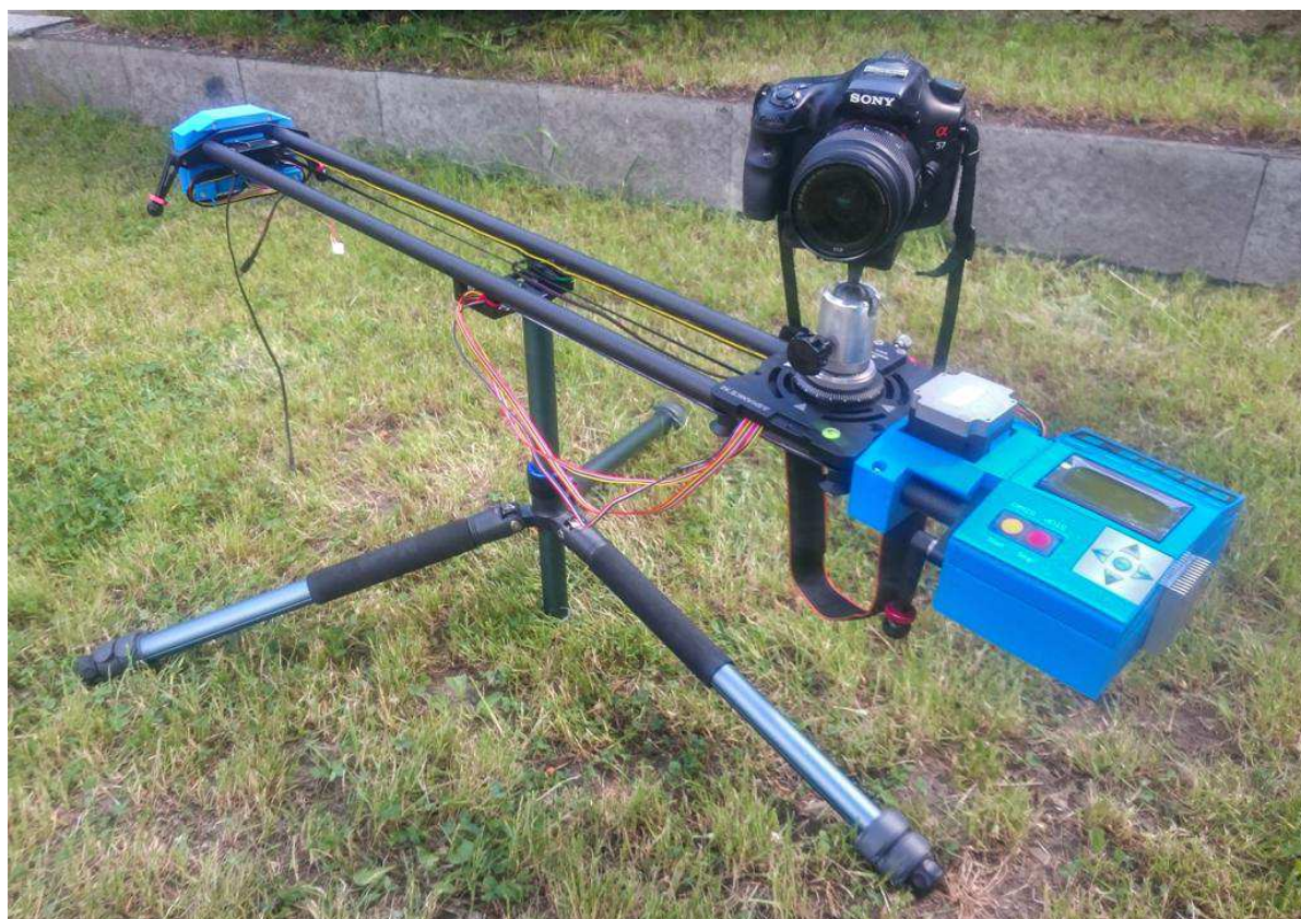
Obr. A12 – Horizontální rozložení stativu bez kulové hlavy. Stabilní v celé délce pojezdu.
