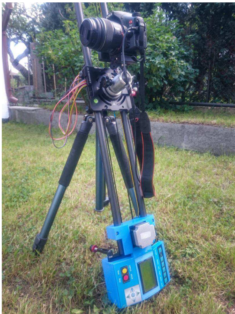
Obr. A13 – Vertikální rozložení stativu v úhlu 45° – 90°. Tažný řemen je nutné dostatečně napnout.
