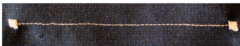
Obr. 2.5 Realizovaný vyšitý rezistor – 100 mm
