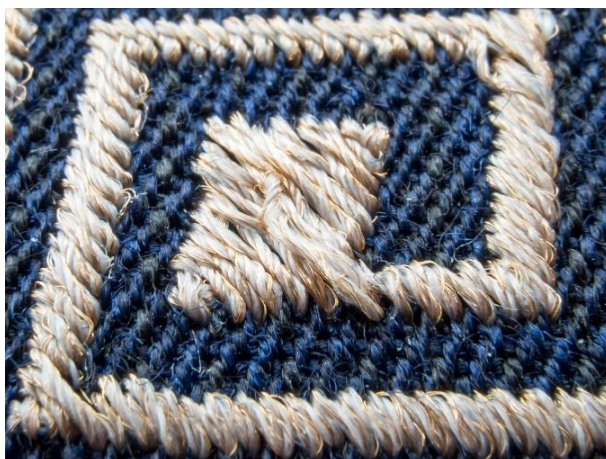
Obr. 1.3 Detail vyšitého motivu pomocí vodivé příze s mosaznými drátky
