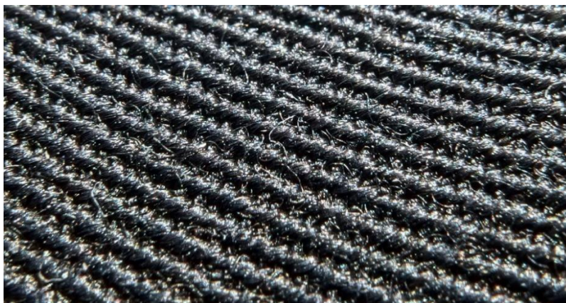
Obr.2.2 Detail použitého vlněného textilního substrátu Nová Mosilana
