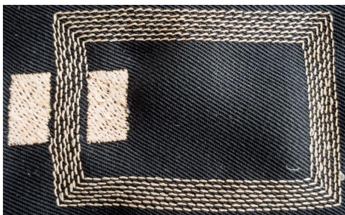
Obr. 1.1 Elektrický obvod vyšitý do textilního substrátu
