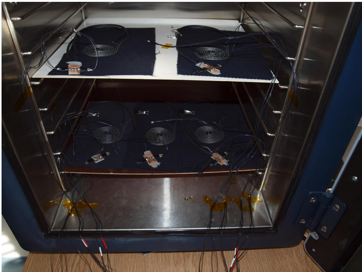
Obr. 4.11 Zapojení senzorů uvnitř pece SalvisLAB thermocenter TC40 při kalibraci
