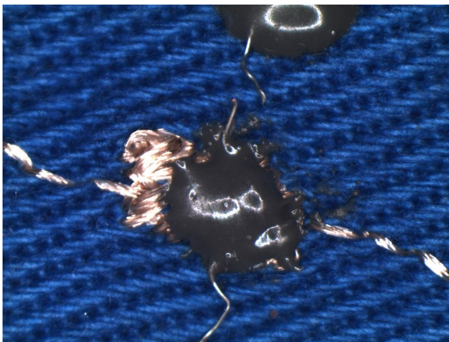
Obr. 4.30 Fyzicky porušený vzorek samostatného přivařeného vodiče
