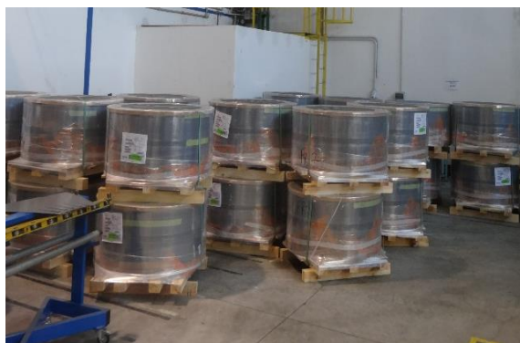
Obr. 5.1 Uskladnění svitků vertikálně (vlastní zpracování)
