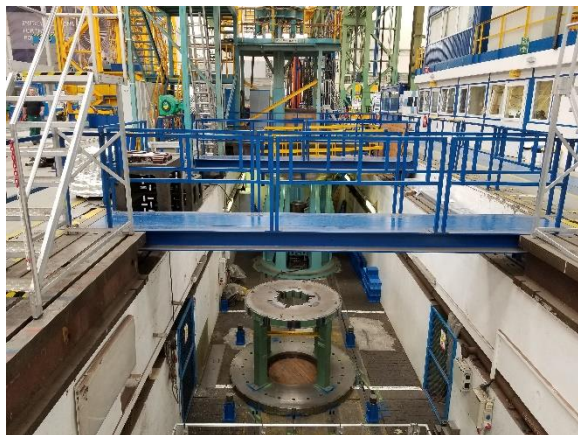
Obr. 5.6 Pracoviště skládání statorových plechů (vlastní zpracování)
