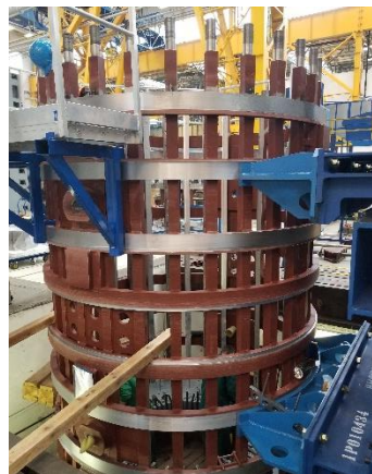
Obr. 5.7 Skládání plechů uvnitř kostry statoru (vlastní zpracování)
