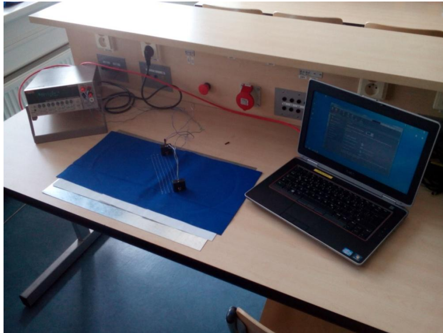
Obr. 3.1 Pracoviště pro měření čtyřvodičovou metodou
