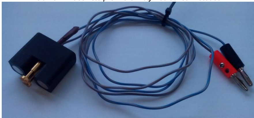
Obr. 3.2 Magnetická sonda určená k měření čtyřvodičovou metodou
