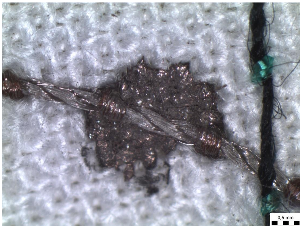
Obr. 3.9 Stabilní kontakt nití 7A vytvořený pomocí vodivého inkoustu
