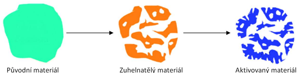
Obr. 1.5 Změny povrchu uhlíku od původního materiálu k aktivovanému
