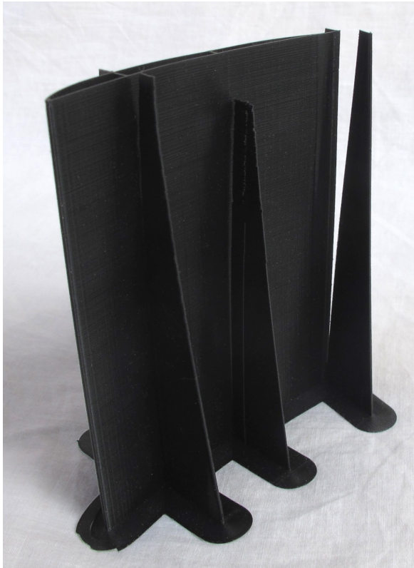
Obrázek 32 - První segment křídla s tiskovými podporami
