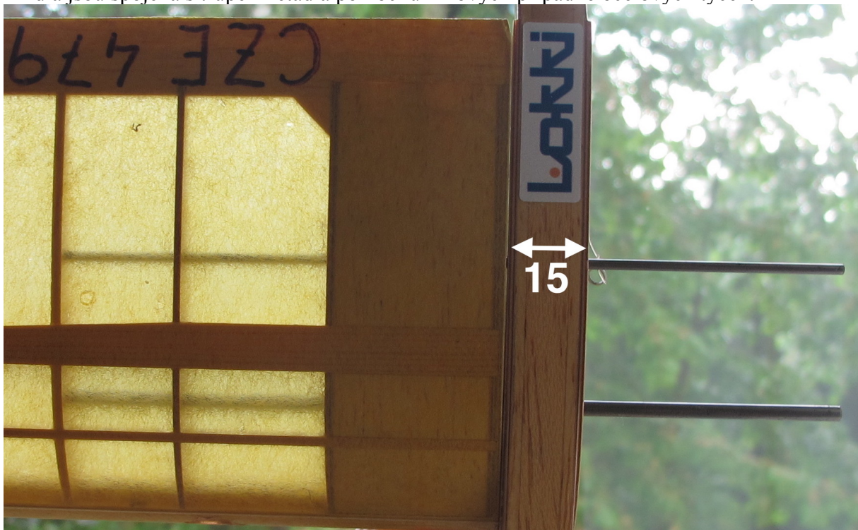
Obrázek 25 - Spojení křídla s trupem letadla
