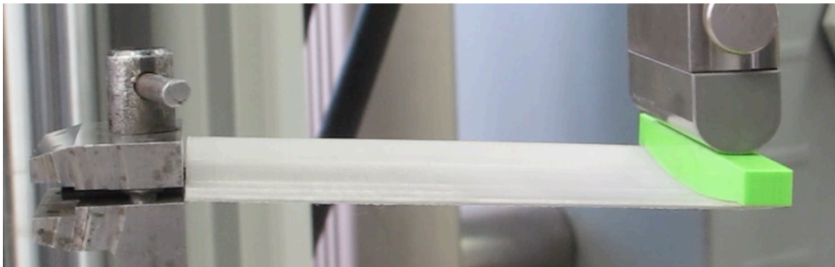
Obrázek 38 – Segment křídla v maximálním průhybu
