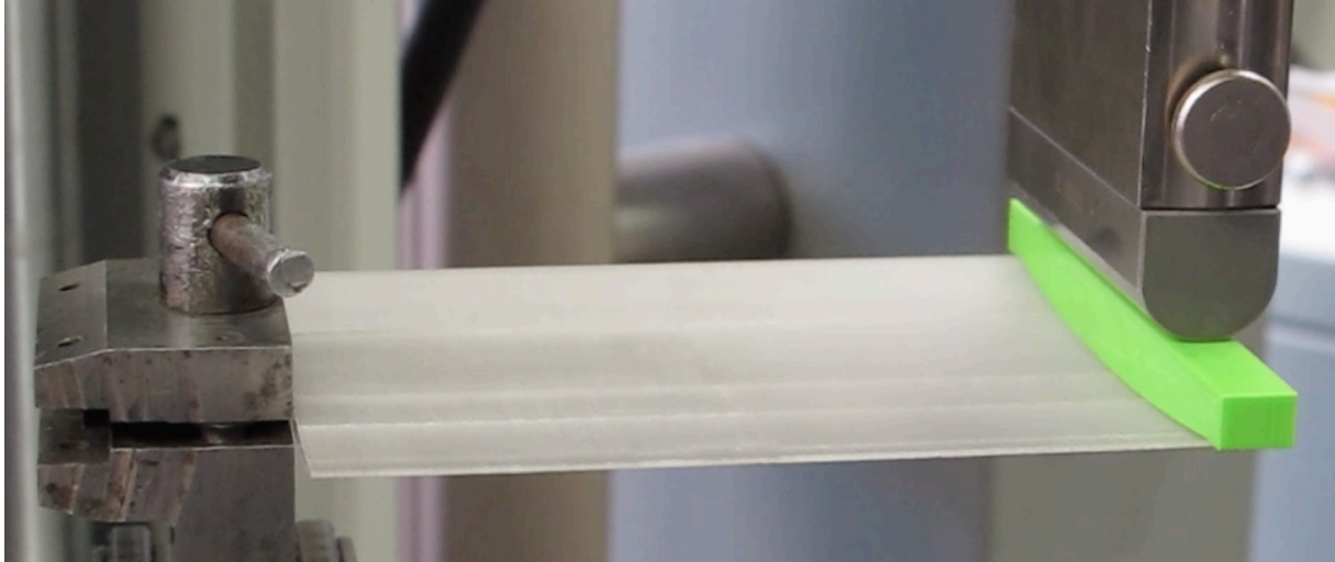
Obrázek 37 – Segment křídla upnutý do měřicího stroje
