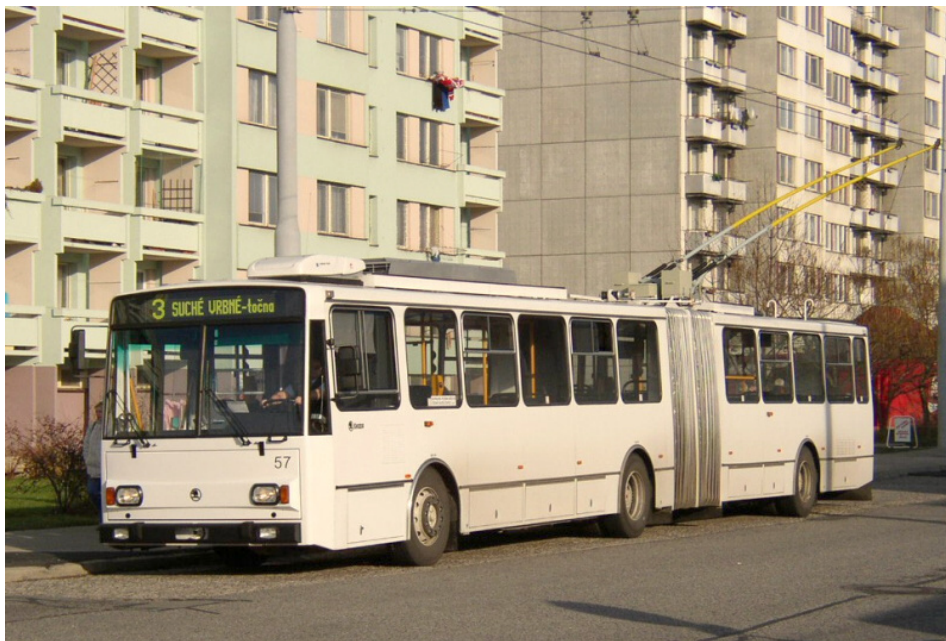
Obr.38: Úplně poslední trolejbus vyrobený v závodě Ostrov nad Ohří - typ 15TrMM vybavený stejnosměrnou trakční výzbrojí s IGBT tranzistory. [68]
