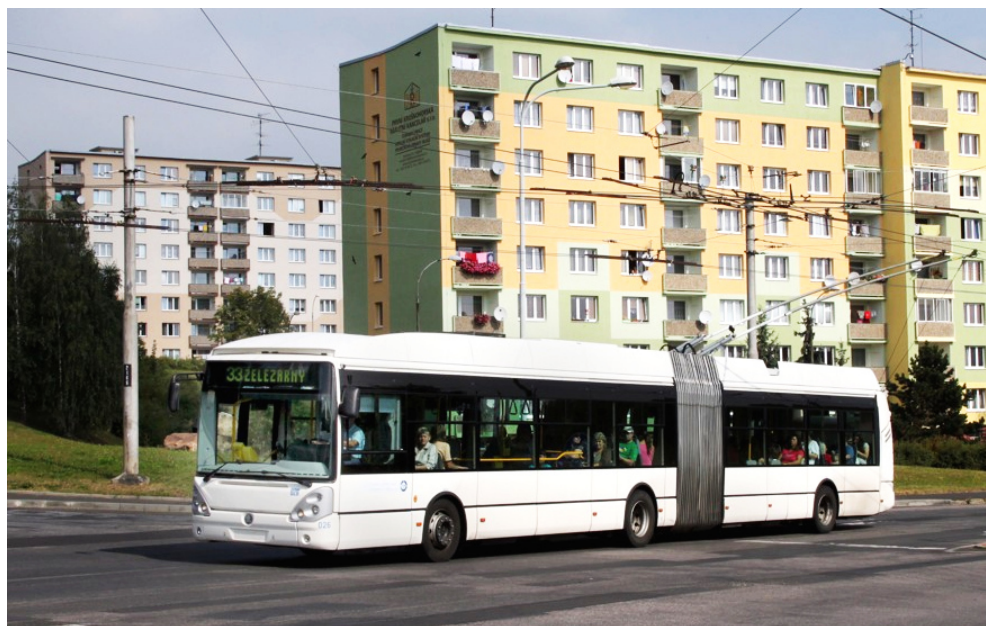
Obr.25: Jediný chomutovský vůz 25Tr ve fádním celobílém nátěru, koncepce člankového vozu s pouze zadní hnanou nápravou se ve zdejších náročném terénu neosvědčila a i z jiných důvodů již proto nebylo v dodávkách pokračováno. [68]
