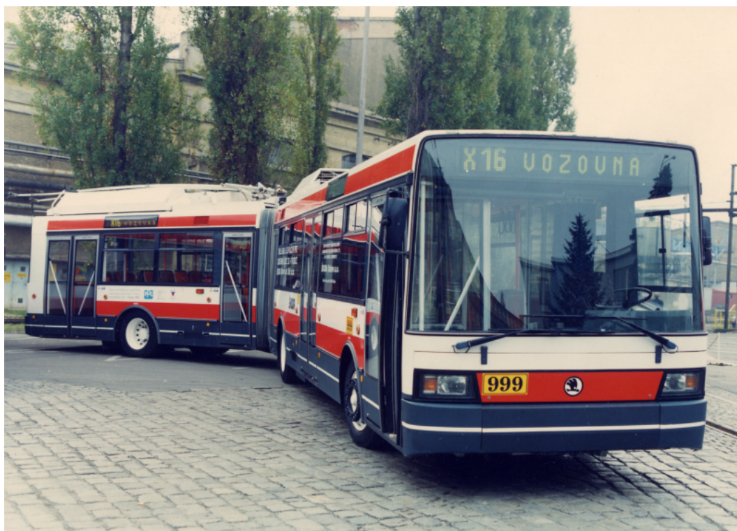
Obr.42: Možný předobraz nové typové řady trolejbusů - článkový částečně nízkopodlažní trolejbus 22Tr. [69]
