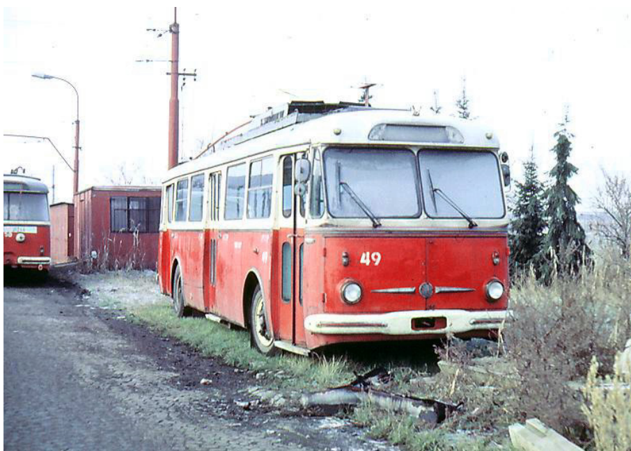
Obr.10: V ČR unikátní a bohužel nedochovaný vůz 9Tr v tzv. verzi "Bergen", lišící se od běžných sériových vozů především rozdílným provedením čelního a zadního okna (užití rovných skel). Obdobné vozy vyrobil ostrovský závod pro norského zákazníka a souběhem výroby se jeden dostal do provozu v Hradci Králové. [25]
