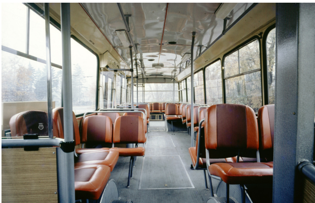
Obr.27: Umakart, koženka, gumokoberec - typický interiér trolejbusů Škoda, zde zpodobněno provedení na typu 14Tr série 05. [69]
