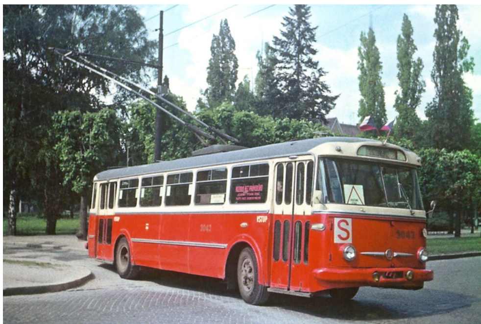
Obr.11: Atypické dvoudveřové provedení trolejbusu 9Tr, dodaného do Brna v rámci tzv. exportního souběhu (tato modifikace se běžně vyráběla pro SSSR) [29]
