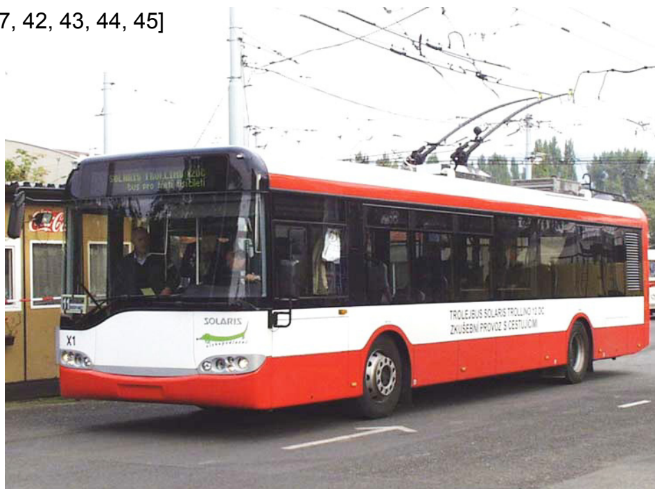
Obr.17: Budoucí opavský trolejbus Solaris Trollino 12 DC, jediný vůz svého typu v ČR se stejnosměrnou trakční elektrovýzbrojí. [66]
