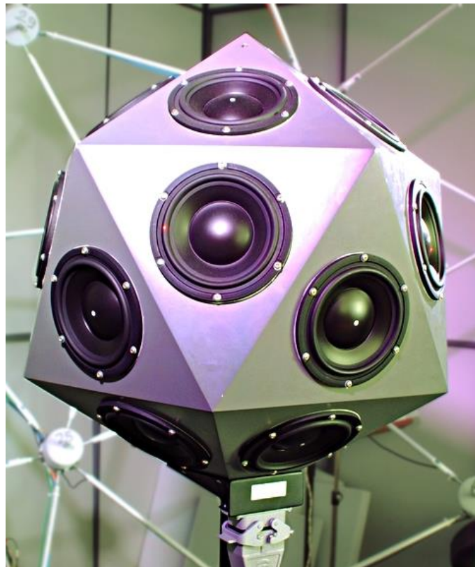
Obr. 3.2.2: Příklad zdroje typu ikosahedron s dvaceti reproduktory – dostupný z [41]
