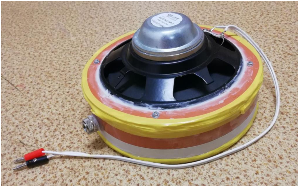
Obr. 4.2.7: Ilustrační foto poloprostorového zářiče o objemu 5 l.
