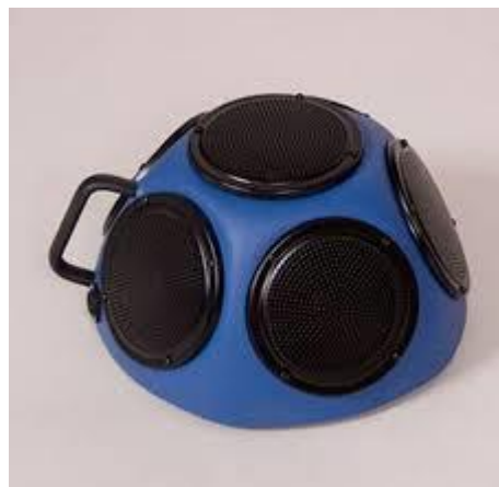
Obr. 3.1.1: Akustický zdroj Norsonic Nor275 - dostupný z [39]
