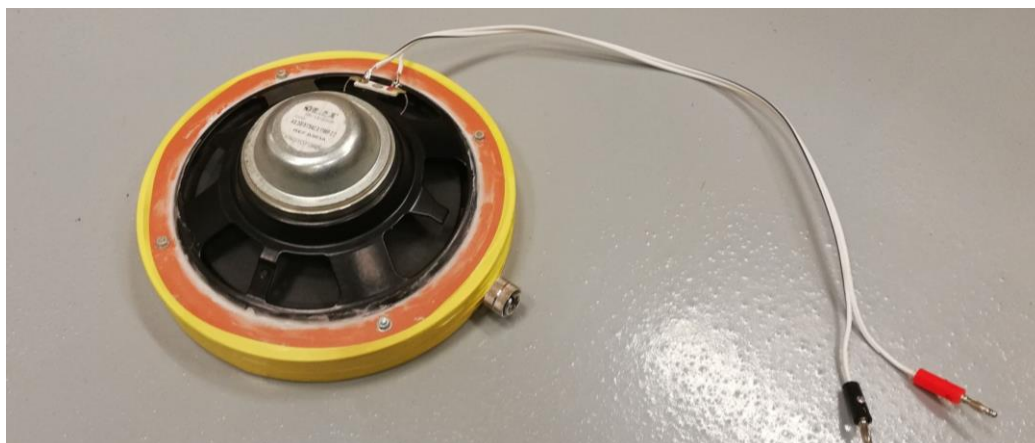
Obr. 4.2.1: Ilustrační foto poloprostorového zářiče o objemu 0,8 l.
