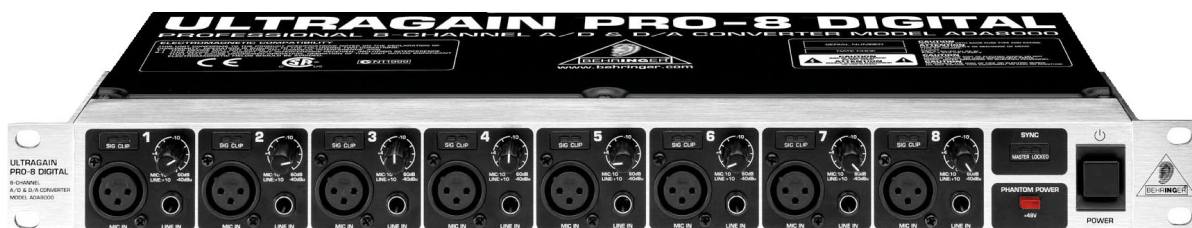
Obr. 3.1: Osmikanálový AD převodník Behringer, model ADA8000
