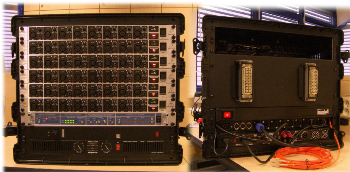
Obr. 2.3: Fotografie rackového boxu obsahující elektroniku pro měření difuzity
