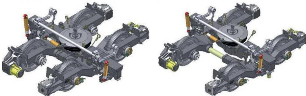
Obrázek 12 - Podvozek EV09 s úzkým (vlevo) a širokém rozchodu [8]
