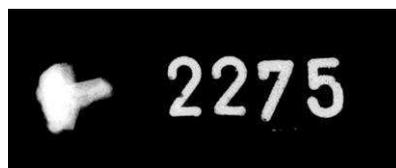
Obr. 27. Železný nýt s polokulovitou hlavičkou, rentgenografický snímek (Hložek 2007).
