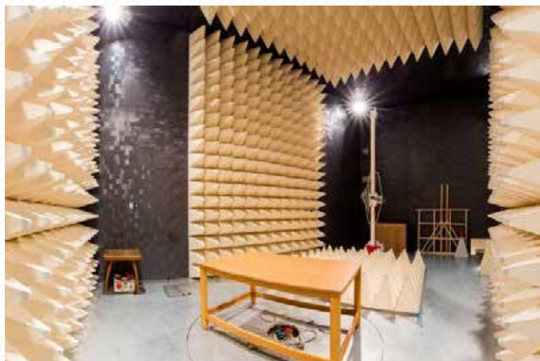
Laboratoř elektromagnetické kompatibility. Částečně bezodrazová stíněná komora je určena jak k měření elektromagnetického rušení zařízení, tak testování jejich odolnosti proti vysokofrekvenčním elektromagnetickým polím.
